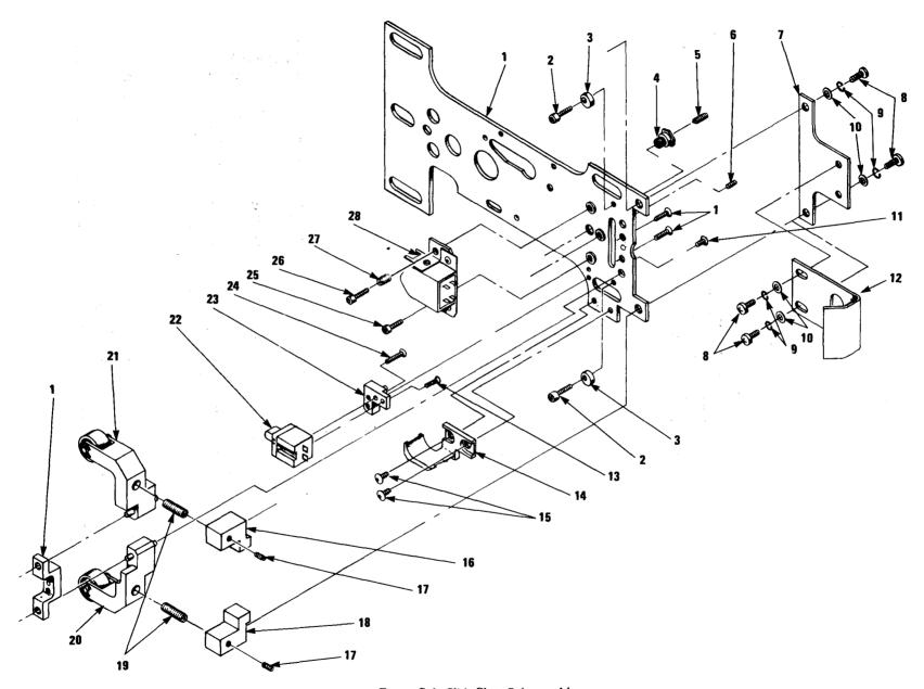
Figure C-6. Slide Plate Subassembly
