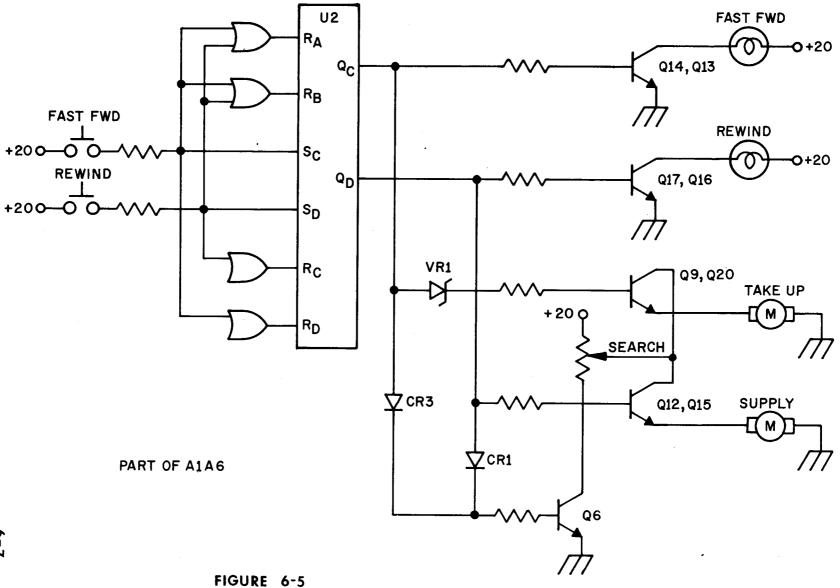
(LOGIC CONTROL CIRCUITRY-PARTIAL SCHEMATIC)
