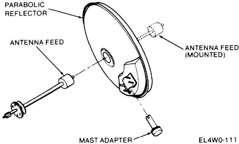
**1-14. RECEIVER-TRANSMITTER ORDER WIRE RT-773/GRC-103(V)**
