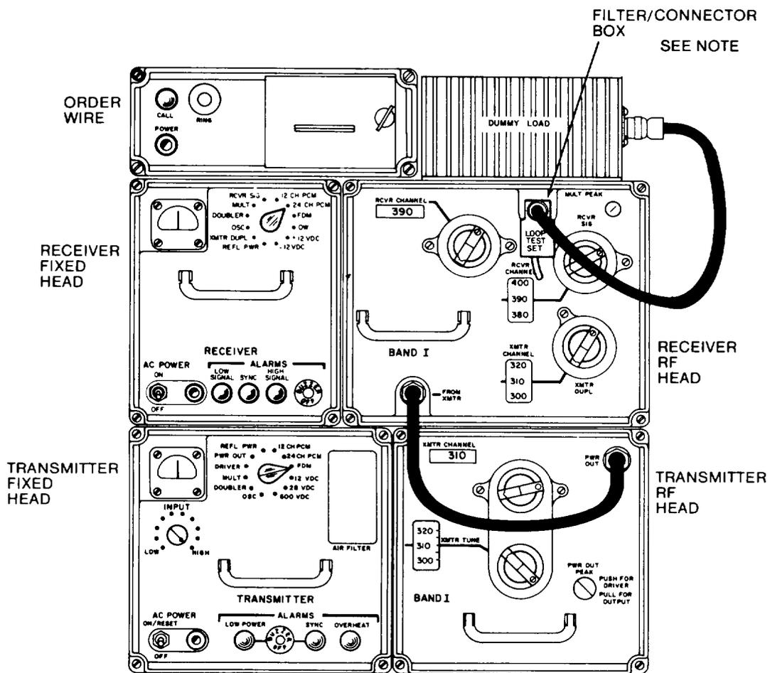
NOTE: LOOP TEST SET IS POWERED BY CONNECTING THE FILTER/CONNECTOR TO THE FDM PLUG AT THE REAR OF THE TRANSMITTER OR TO POWER SUPPLY PP 6617/GRC-103(V).
