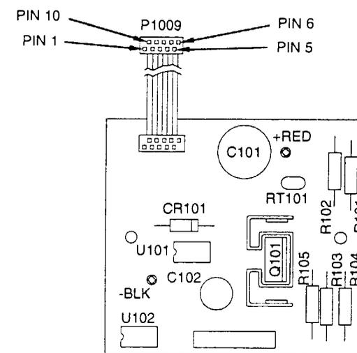
BATTERY PACK CHARGING ASSEMBLY COMPONENT LOCATOR
