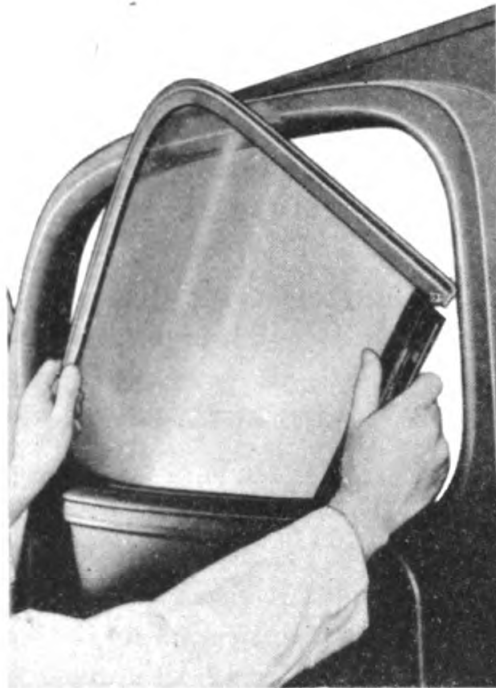
1—REMOVING DOOR GLASS
