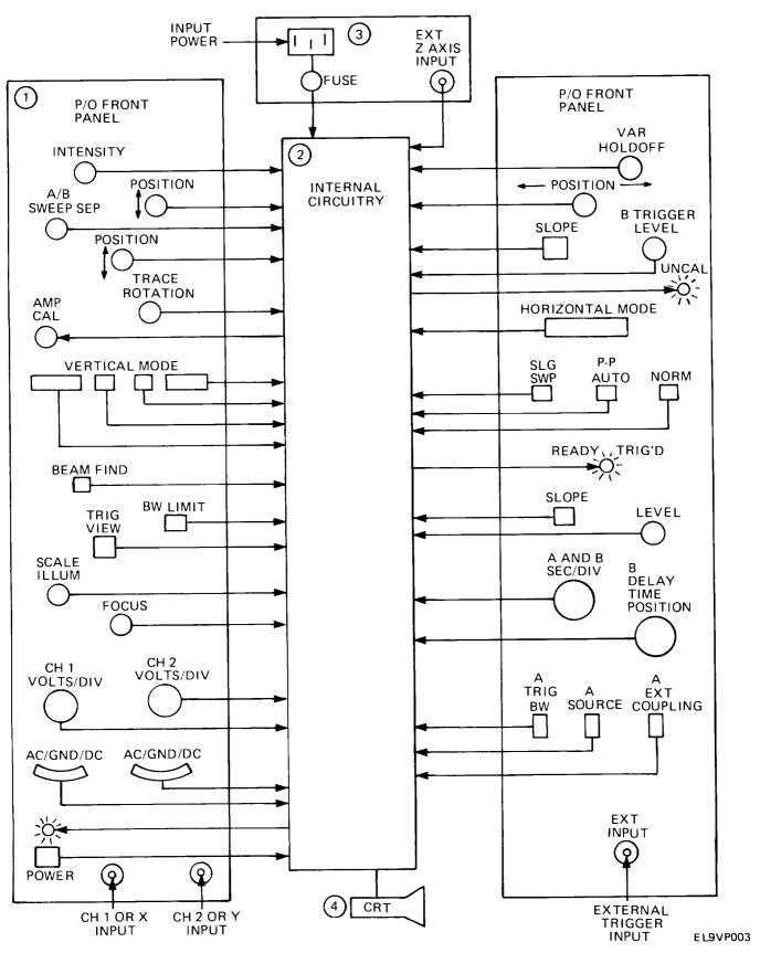
FIGURE 1-2. OSCILLOSCOPE GENERAL BLOCK DIAGRAM
