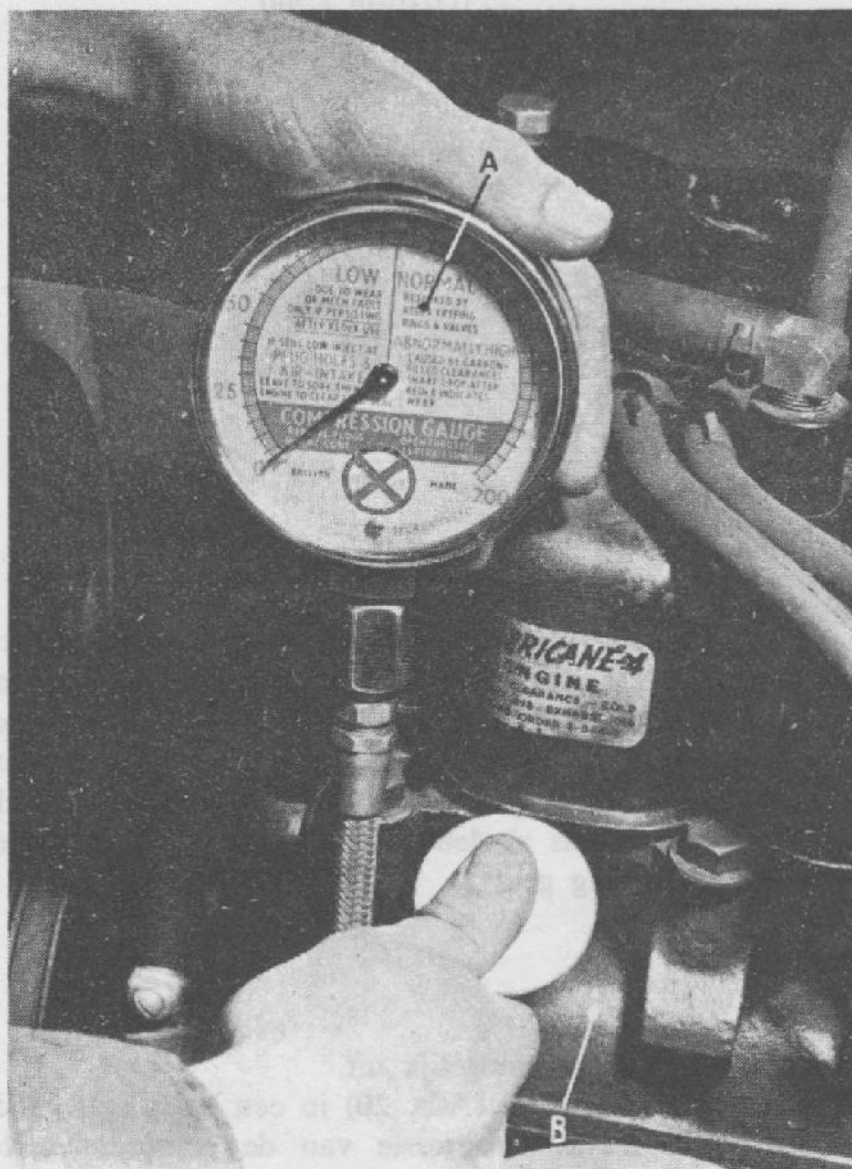
Afb. 20. Het controleren van de motorcompressie
