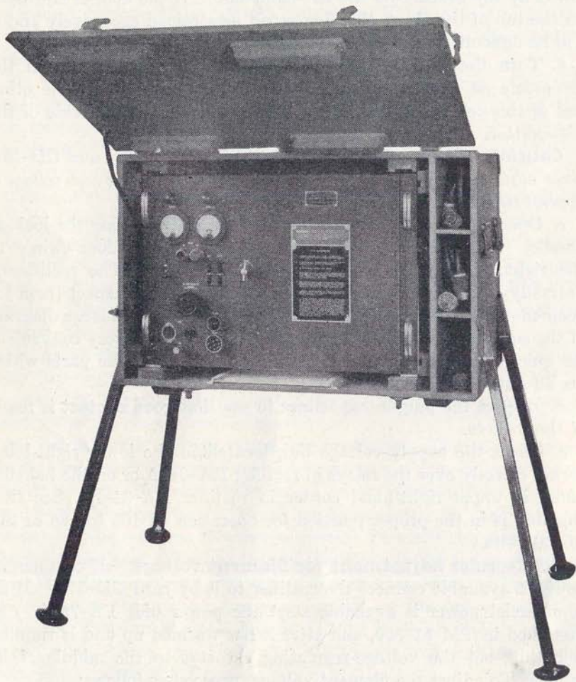
FIGURE 10.—Rectifier RA-34-A in chest CH-57-A.
