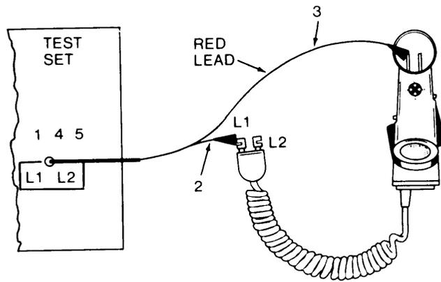
**5-45. INSULATION RESISTANCE TEST**
